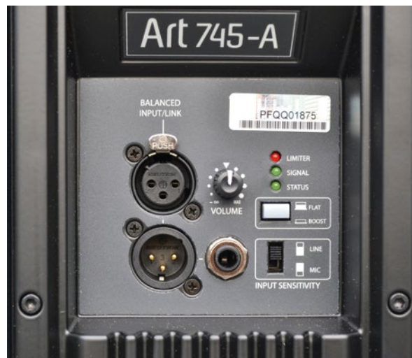
Na panelu przyłączeniowo-regulacyjnym ART-a, oprócz gniazd sygnałowych i regulatora poziomu głośności, znajduje się przycisk wyboru trybu pracy (korekcji) zestawu (FLAT/BOOST).
