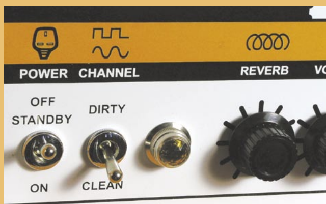
Na przednim panelu znajdują się dwa przełączniki, z których pierwszy (POWER) odpowiada za włączenie wzmacniacza, a drugi (CHANNEL) realizuje przełączanie między kanałami.
