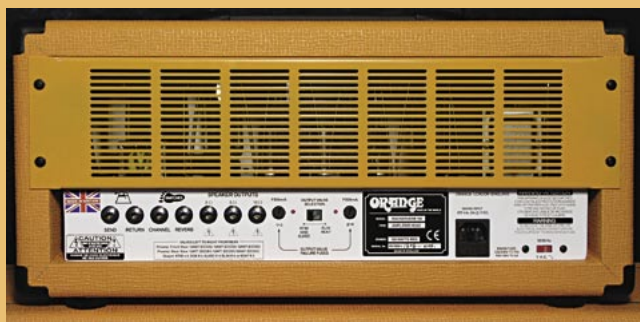
Oprócz zestawu standardowych gniazd, na tylnym panelu znajdują się diody LED, informujące o uszkodzeniu lamp mocy.
