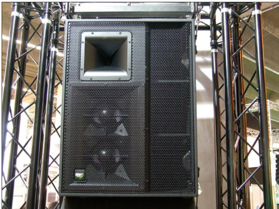
Moduł średnio/wysokotonowy VHD 2.0 wyposażony został w jeden neodymowy driver ciśnieniowy o średnicy 3" i wyjściu 1.4", dwa średniotonowe głośniki 8-calowe z neodymowymi magnesami oraz dwa średnio/niskotonowe głośniki o średnicach 12".
