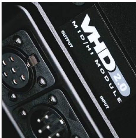
Wejścia i wyjścia sygnałowe zrealizowane są na złączach 6-pinowych.
