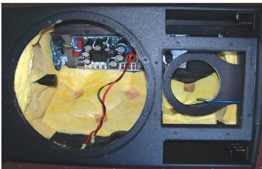
Wnętrze obudowy, kryjące całą elektronikę, wytłumione jest w celu uniemożliwienia powstawania fal stojących.
