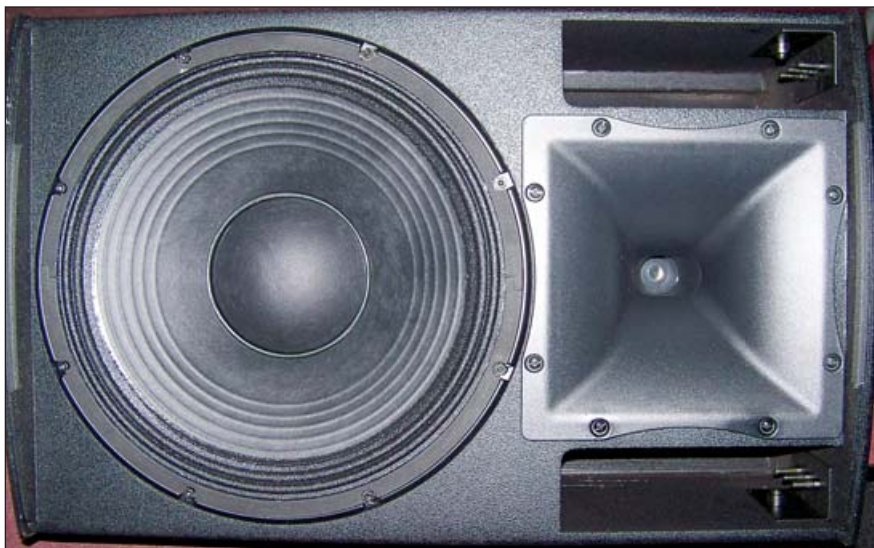
TT25-A to aktywny, dwudrożny zestaw głośnikowy z obudową typu bass-reflex.
